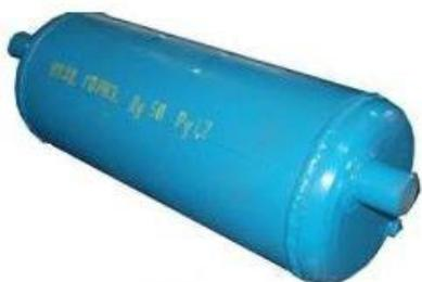
**Воздухосборники** применяются для воздушных стационарных компрессоров общего назначения. Предназначены для создания запаса воздуха для технологических нужд и сглаживания пульсации в воздухопроводах при работе поршневых компрессоров общего назначения и компрессоров других типов с избыточным давлением не более 0,785 МПа (8 кгс/см<sup>2</sup>). **Воздухосборник** представляет собой цилиндрический вертикальный сосуд с эллиптическими днищами, люком и арматурой. Рабочая среда — воздух.
