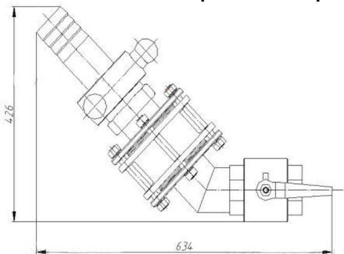
Общий вид устройства сливного УС–80А–135
