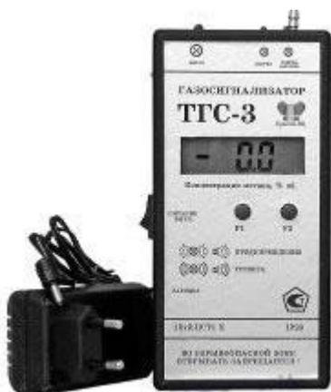
Газосигнализаторы ТГС-3М-И (метан  $\text{CH}_4$  и аналоги) и ТГС-3СО-И (оксид углерода  $\text{CO}$ ) предназначены для комплексного контроля и индикации содержания контролируемого газа и выдачи световой и звуковой сигнализации по двум уровням концентрации контролируемого газа.
