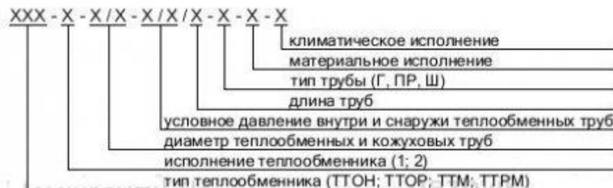
А также двух исполнений: 1 — с приварными двойниками, 2 — со съёмными двойниками.
