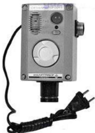
Предназначен для выдачи сигнализации о превышении установленных значений объемной доли горючих газов и массовой концентрации оксида углерода в воздухе. Область применения: в помещениях котельных; в жилом секторе коммунального хозяйства, а также в шахтах, колодцах, на автостоянках и других объектах, где возможно выделение и скопление угарного газа.
