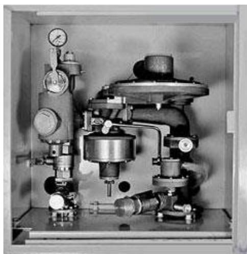
Шкафные газорегуляторные установки предназначены для снижения среднего или высокого входного давления природного газа до низкого, автоматического поддержания заданного давления на выходе в установленных пределах, очистки газа фильтром тонкой очистки, кратковременного сброса избыточного давления газа в сбросную линию, а также для автоматического отключения подачи газа при аварийном повышении или понижении выходного давления сверх допустимых заданных значений.
