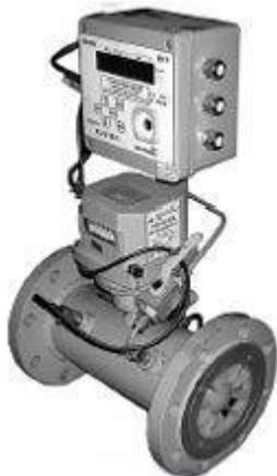
Комплекс СГ-ЭК со степенью защиты IP64 по ГОСТ 14254 устойчив к воздействию пыли и воды. При своей работе устойчив к воздействию внешнего электромагнитного поля напряженностью переменного поля — до 40 А/м, постоянного поля — до 400 А/м. Также устойчив к воздействию синусоидальной вибрации в соответствии с ГОСТ 12997, группа исполнения № 3.
