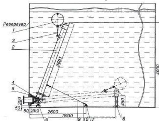
Общий вид плавающего заборного устройства ПЗУ-250:
