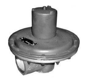
Клапан пружинный сбросной ПСКУ-50 является прибором мембранного типа прямого действия и предназначен для ограничения давления неагрессивных газов путем сброса газа в атмосферу до установленной величины при повышении давления в сети сверх допустимого предела.
