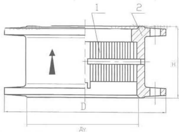
Предохранитель огневой жидкостный ПОЖ–80
