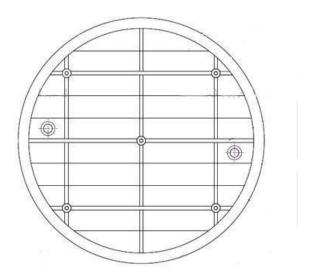
Алюминиевый подвесной понтон предназначен для сокращения потерь нефти и нефтепродуктов из вертикальных цилиндрических резервуаров объемом от 100 до 50 000 м3.
