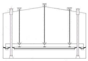
Для исключения вращения понтона используются две направляющие, которые одновременно могут выполнять технологические функции - в них располагаются измерительное устройство и устройство для отбора проб продукта. По решению заказчика может устанавливаться только одна направляющая.
