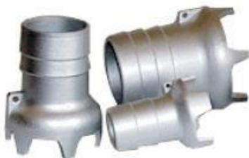
Наконечники серии НК («корона») предназначены для зачистки дна резервуаров нефтебаз и АЗС. Наконечники НК устанавливаются в заборный рукав. К отверстию в проушине прикрепляется страховый тросик, одновременно выполняющий функцию заземления. Наконечники НК опускаются на дно резервуара, производится зачистка резервуара. Наконечники НК изготавливаются в 3-х исполнениях:
