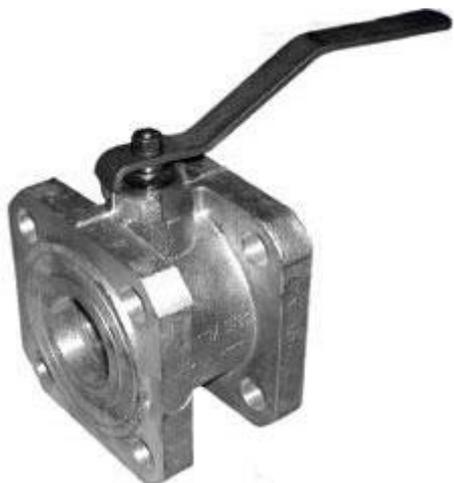
Кран шаровой КШ-50 является запорной арматурой и предназначен для газовой среды: природный газ ГОСТ 5542-87 и сжиженный газ ГОСТ 20448-90. Кран устанавливается на газопроводах низкого, среднего и высокого давления, а также на регуляторных станциях. Условия эксплуатации крана соответствуют климатическому исполнению УХЛ2 ГОСТ 15150-69 с температурой окружающей среды от -40 до +65 °С.
