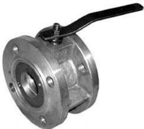
Кран шаровой КШ-50 является запорной арматурой и предназначен для газовой среды: природный газ ГОСТ 5542-87 и сжиженный газ ГОСТ 20448-90. Кран устанавливается на газопроводах низкого, среднего и высокого давления, а также на регуляторных пунктах. Условия эксплуатации крана соответствуют климатическому исполнению УХЛ2 ГОСТ 15150-69 с температурой окружающей среды от  $-40$  до  $+60$  °С.
