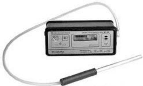
Искатель утечек горючих газов ИГ-10 предназначен для определения мест утечек природного и сжиженного газов из подземных газопроводов непосредственно с поверхности грунта или дорожного покрытия над газопроводом, а также для обнаружения неплотности швов, фланцев и сварных соединений наружных газопроводов и газовой арматуры. Взрывозащищенное исполнение ИГ-10 позволяет использовать прибор в условиях, когда наличие и степень загазованности заранее неизвестны.
