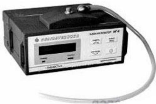
Взрывозащищенный портативный газоанализатор ИГ-8 предназначен для измерения концентрации двух горючих газов или паров, а также концентрации кислорода и окиси углерода в атмосфере помещений и наружных установок. Подача контролируемой газовой смеси на датчики — принудительная посредством встроенного побудителя или диффузионная.
