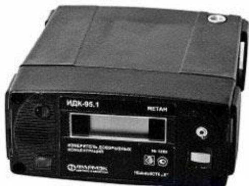
Прибор с цифровой индикацией и встроенным микронасосом, предназначенный для измерения дозрывных концентраций горючих газов в атмосфере производственных помещений, в колодцах, подвалах, скважинах и т. д., в которых возможно образование взрывоопасных смесей газов или паров с воздухом категорий IIA, IIB, IIC, групп T1...T6 по ГОСТ Р 51330.11-99, ГОСТ Р 51330.2-99, ГОСТ Р 51330.5-99, ГОСТ Р 51330.19-99.
