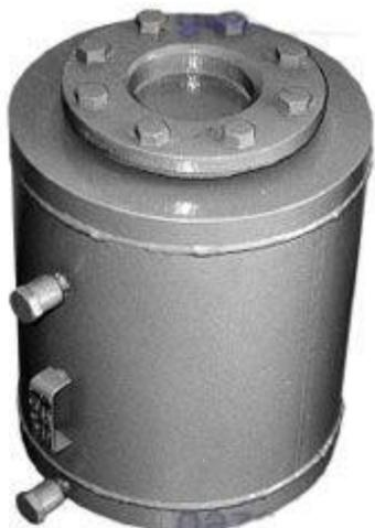
Фильтры газовые сетчатые прямооточные ФГП (ФГС) предназначены для очистки неагрессивных газов и воздуха от механических примесей. Материал корпуса — стальной сварной. Фильтрующий элемент — сетка металлическая, нержавеющая, с ячейкой в свету 0,25×0,25 мм, которая сохраняет все технические характеристики при температуре окружающей среды от -30 до +50 °С.
