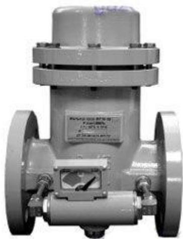
Фильтры газовые серии ФГ-16 предназначены для очистки от механических частиц природного газа, а также воздуха, азота и других неагрессивных газов при рабочей температуре очищаемого газа от -40 °С до +70 °С и температуре окружающей среды от -40 °С до +70 °С и применяются для установки на газопроводах перед измерительными приборами, запорнорегулирующей арматурой, газогорелочными устройствами котлов и других газосжигающих установок для повышения надежности и долговечности работы оборудования.
