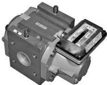
Счетчики RVG предназначены для коммерческого и технологического учета объемов потоков очищенных и осушенных газообразных сред: природного газа, пропана, водорода, воздуха, азота и инертных газов. Счетчик RVG измеряет прошедший через него объем газа при рабочих условиях, т. е. не приведенный к стандартным условиям. Счетчики RVG предусматривают возможность работы с электронным корректором объема ЕК-260 и температурным корректором объема ТС-210.
