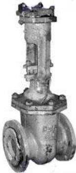
30нж941нж — природный газ влажный, нефтепродукты, содержащие сероводород до 0,1%, жидкие и газообразные нефтехимические продукты, скорость коррозии в которых стали 12Х18Н9ТЛ не более 0,2 мм/год, при температуре среды до 565° С, минимальная температура окружающего воздуха –60° С;
