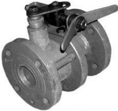
Предназначен для установки в качестве запорного устройства, полностью перекрывающего поток рабочей среды на трубопроводах, транспортирующих: газ, воду холодную, горячую и прочие слабоагрессивные среды при температуре от  $-30$  до  $+200$  °С. КЗШС изготавливается в двух исполнениях:
